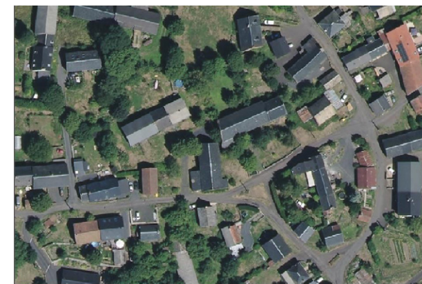
Vue aérienne du «quartier historique» des Bravant : les toitures sont majoritairement à deux pans, et couvertes d'ardoise ; quelques croupes et toitures en tuile sont aussi présentes
